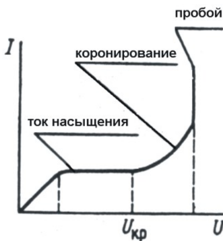
Рис. 18. Зависимость силы тока от напряжения между электродами
