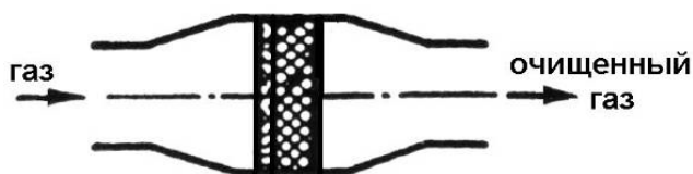
Рис. 12. Схема процесса фильтрования
